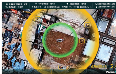
實時AI監控與警報 吊鉤追蹤 / MIC吊架檢測 地面危險區域人員警示
