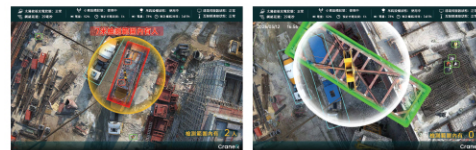
實時AI監控與警報 吊鉤追蹤 / MIC吊架檢測 地面危險區域人員警示
